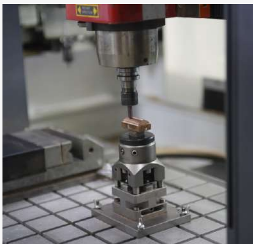
Macchina Utensile equipaggiata con GibbsCAM per le lavorazioni 3D, lavorazione di finitura
